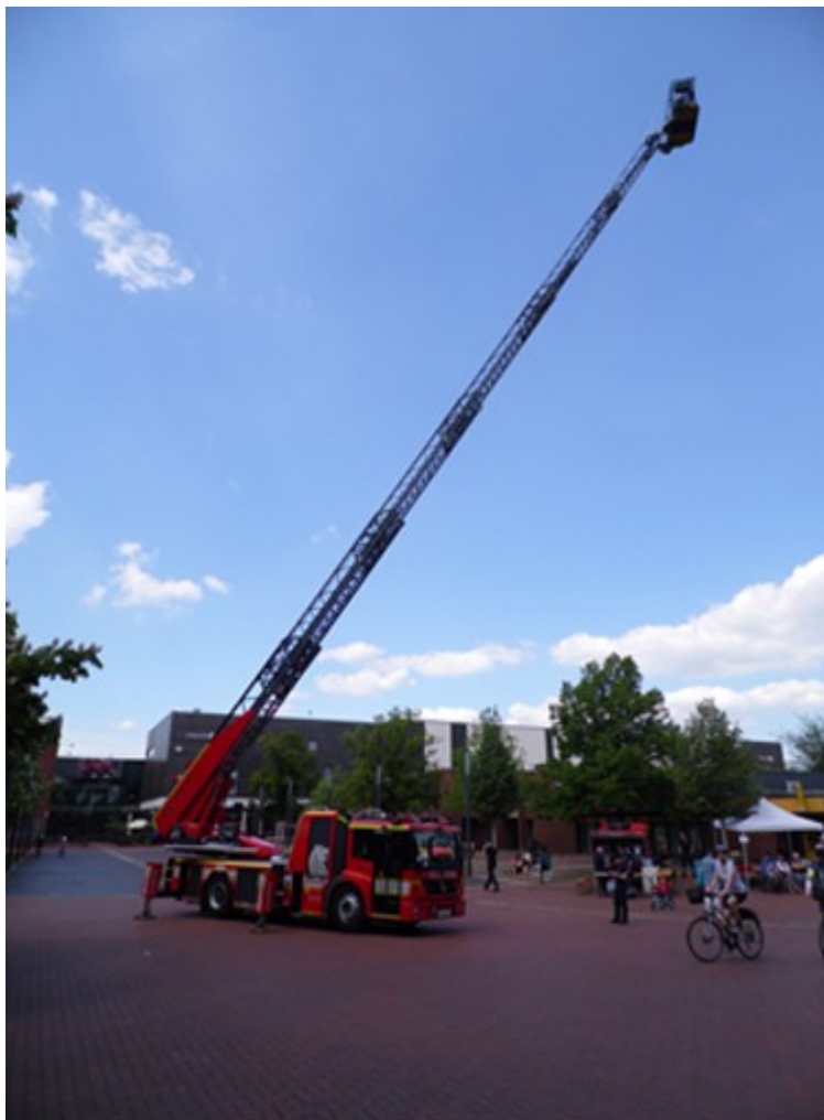
Die Drehleiter bei einem Übungseinsatz auf dem Marktplatz, die Leiter mit dem Rettungskorb ist in voller Länge ausgefahren
