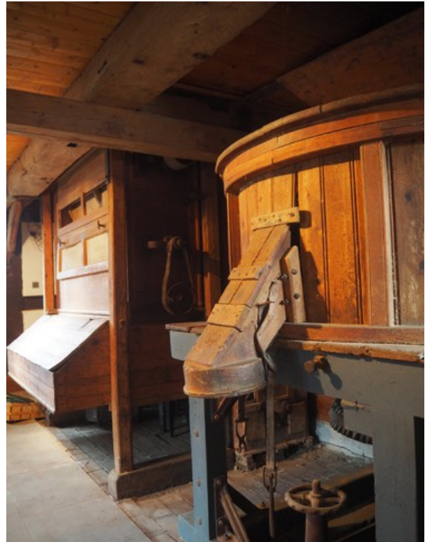
Im Vordergrund das Mahlwerk, dahinter die Mehlsiebe 23
